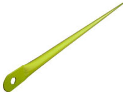
Связь горизонтальная изготовлена из трубы О 25х1,5 мм. Имеет габариты – длина 3050 мм, масса 3,25 кг, длина 2000 мм, масса 2,12 кг. Служит для связи вертикальных рам и обеспечения необходимой дистанции между ними.
