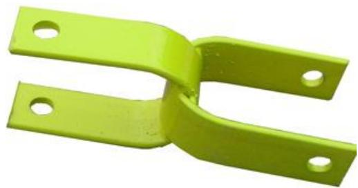
Хомуты изготавливаются из полосы 30\*4 мм. Служат для соединения рамных лесов друг с другом при помощи хомутовой стяжки. Или крепления консолей строительных лесов.
