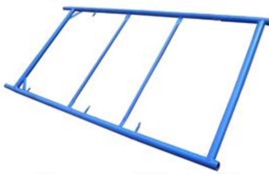
Рама ЛРП 2000-30 изготовлена из трубы, 42\*1,5 мм. Имеет габаритные размеры – высота - 2000 мм, ширина - 1000 мм, масса 12,5 кг. На рамках предусмотрены замки (с фиксатором для крепления диагональных стяжек и связей), а также горизонтальное ограждение согласно ГОСТ 27321-87.
