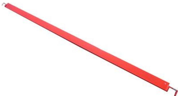
Ригель изготовлен из профильной трубы 60x30x2,5 мм. Имеет габариты - длина 3065 мм, масса 9 кг. (длина 2000 мм, масса 8 кг.) Служит опорой для укладки деревянного настила. Ригели настилов навешиваются с помощью кронштейнов на верхние связи смежных рам на ярусах, предусмотренных под настилы. Сначала укладываются металлические ригеля, а затем укладывается деревянный настил.
