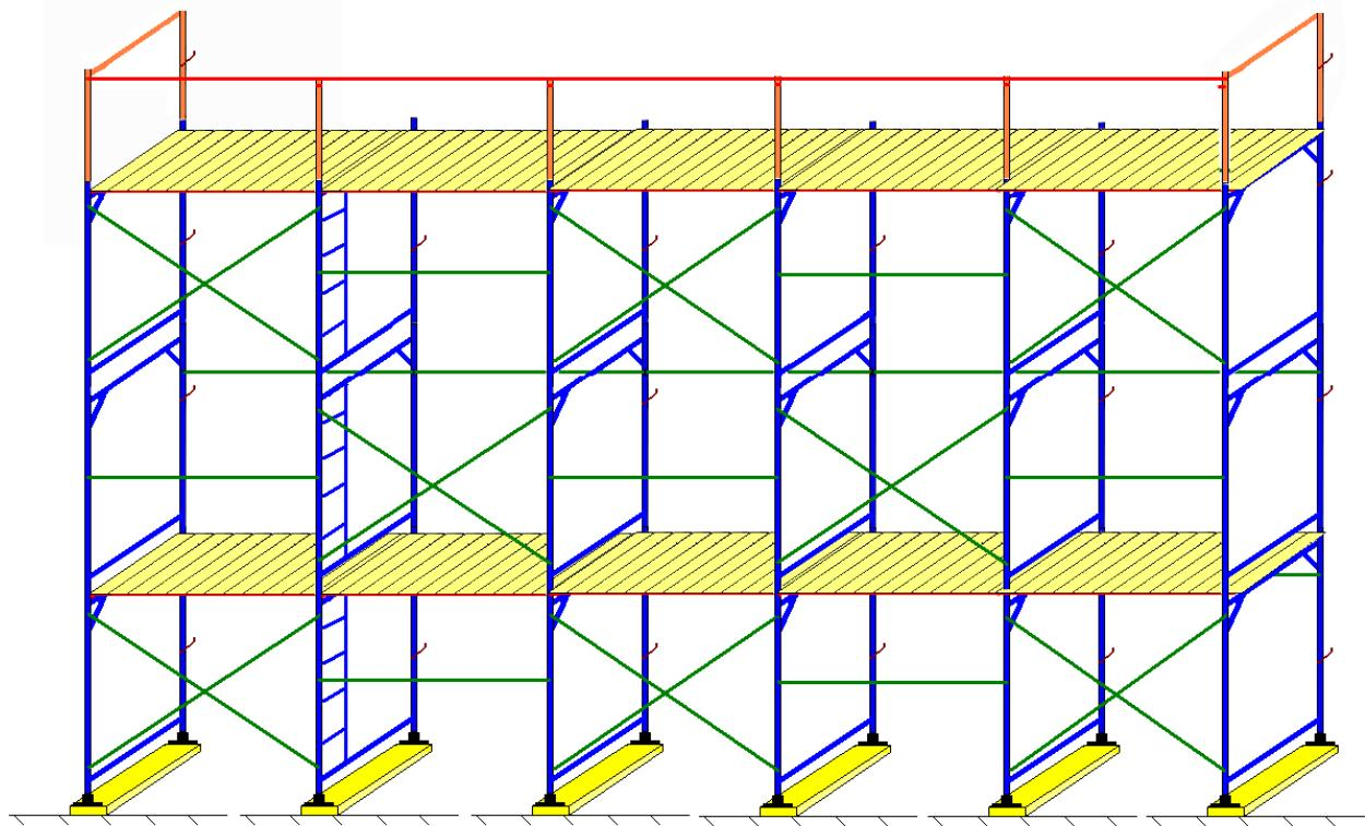
На рабочем ярусе установить ограждения. Перила ограждения должны выдерживать сосредоточенную статическую нагрузку 70 кгс, приложенную к ним посередине и перпендикулярно. Все несущие горизонтальные связи должны выдерживать сосредоточенную статическую нагрузку 130 кгс, приложенную посередине.
